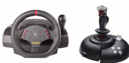
FIG. 1.6 – volant et joystick à retour d'effort
