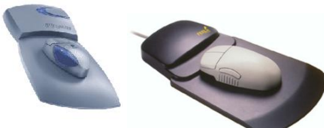
FIG. 1.8 – Wingman Force Feedback et FEELit
